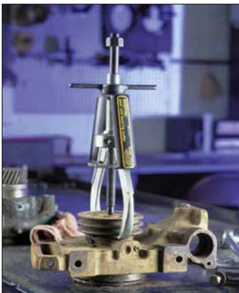
◀ Un estrattore a griffe EP-204 posizionato per estrarre una puleggia dall'albero di una pompa dell'acqua.
