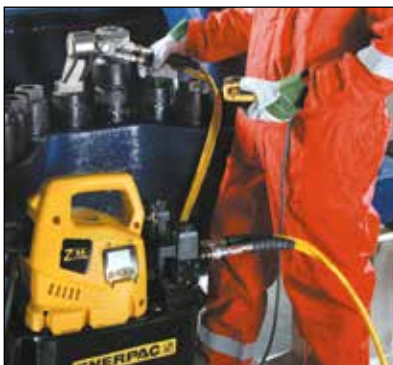
◀ Le pompe portatili della serie ZU4T per chiavi dinamometriche possono azionare chiavi dinamometriche idrauliche di qualsiasi marca.
